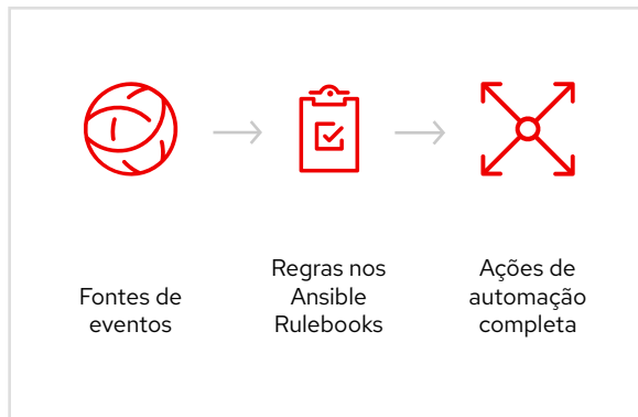
Figura 1. Como o Event-Driven Ansible funciona com fontes, regras contidas nos rulebooks e ações.
