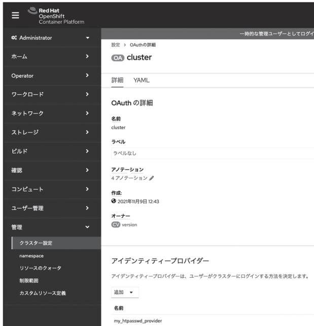
図 4.2 Identity Provider を Web コンソールで設定
